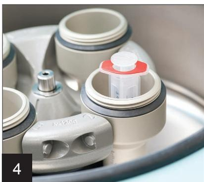
1500RPMで5分間遠心したら、慎重にシリンジを取り出してください。
