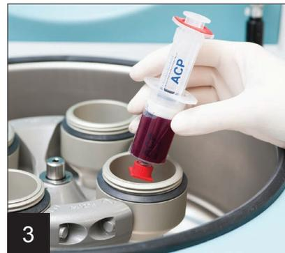
血液の入ったシリンジをバケットに設置し、カウンターウェイトをシリンジと対側のバケットに設置してください。
